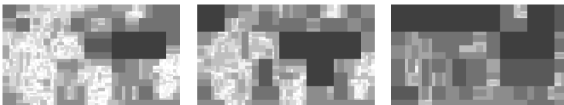
図 5.1 BasketballDrill シーケンスの 100 フレーム目の TU 画像 (左から, QP22, QP32, QP42)
