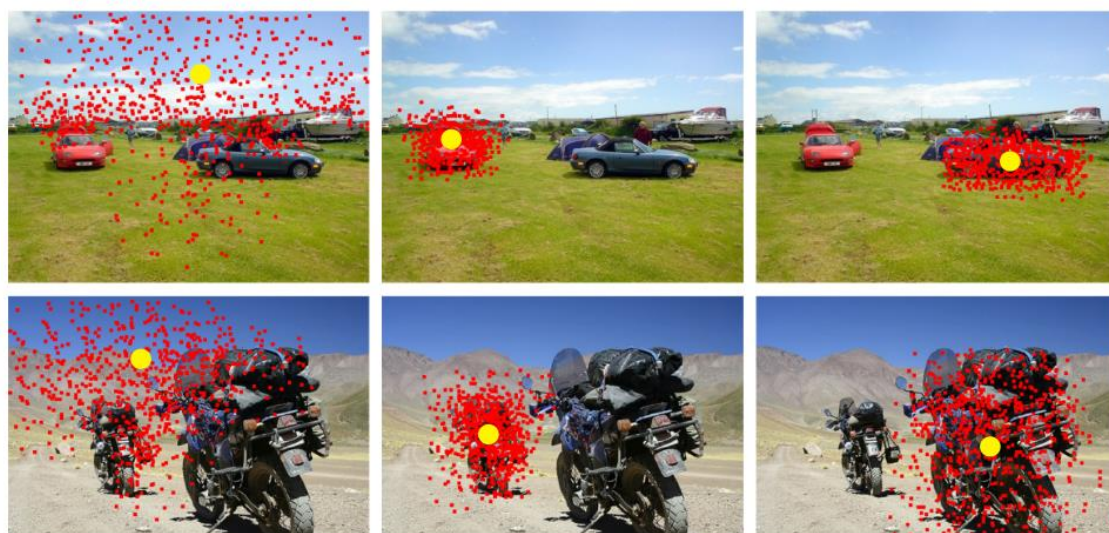
図 3.2 Deformable Convolution における畳み込み箇所 (黄点) とその受容野 (赤点) [2]
