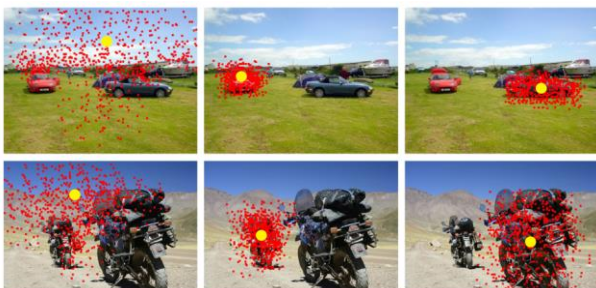
図1 Deformable Convolutionにおける畳み込み箇所(黄点)とその受容野(赤点)[1]
