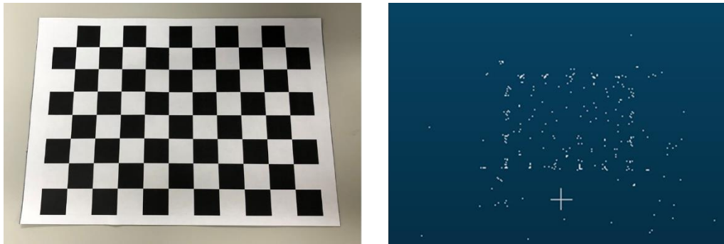
図 5.4 チェッカーボードと ORB-SLAM の点群
