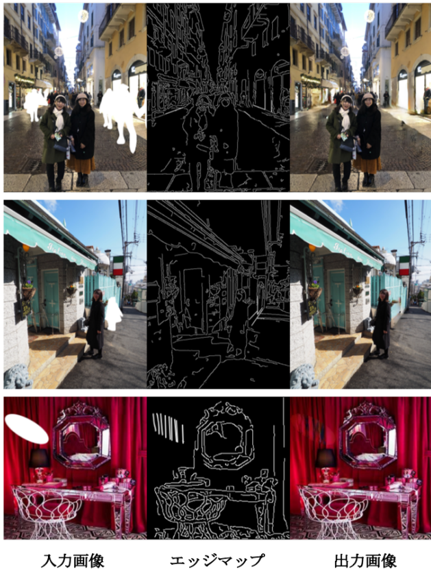
図 3 エッジマップ生成結果および画像修復結果
