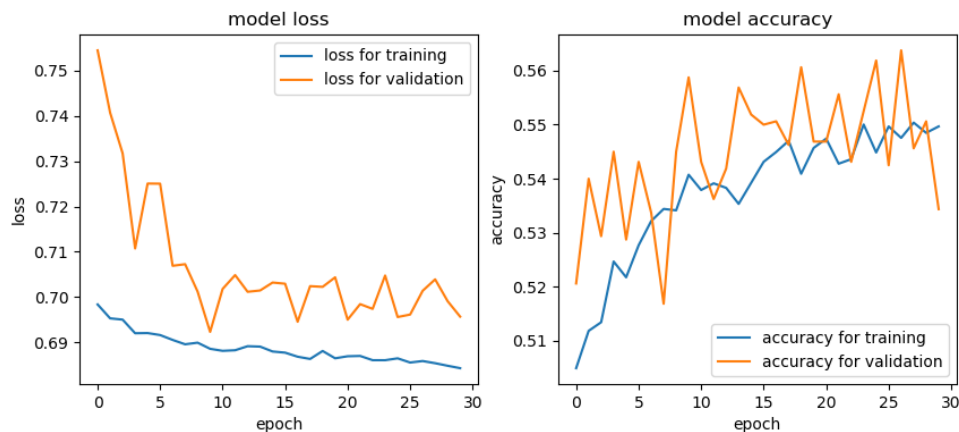
図 4.3 平均腐食深さ学習時の損失と正解率の変化
