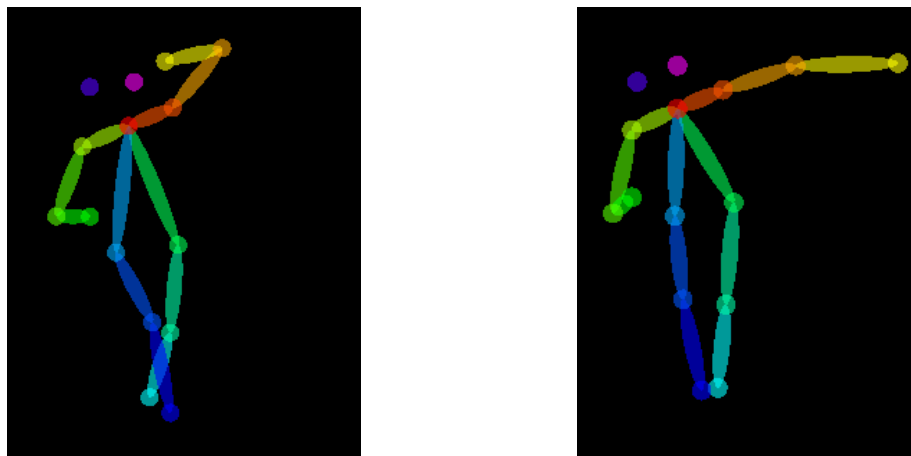
図 3.8 カメラ性能と動作速度による動作部分の欠損
