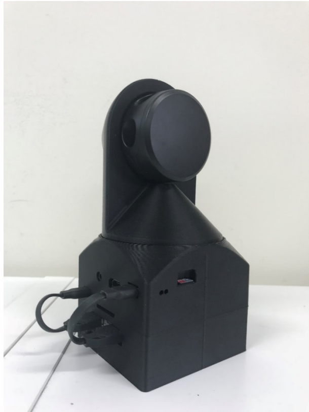
図 2.3 3D Scanner Kit を用いて組み立てた sweep
