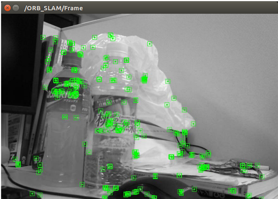
図 4.17 ORB-SLAM による 3 次元特徴点検出 2/4(入力: カメラ画像)
