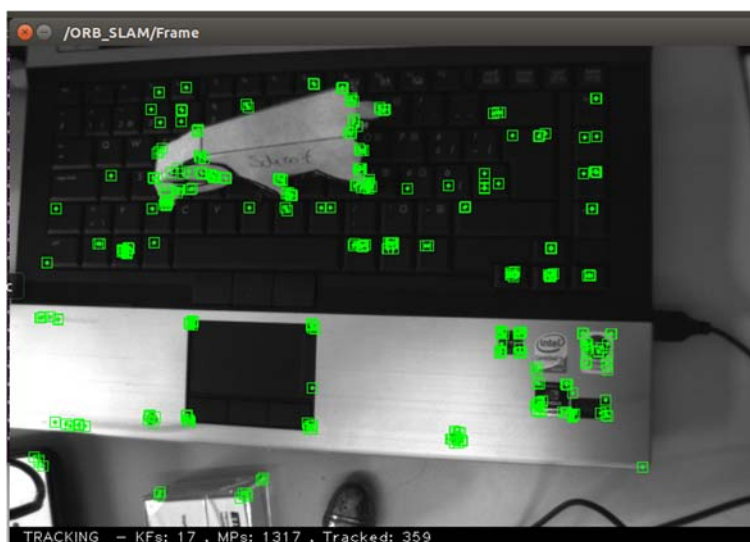
図 4.5 ORB-SLAM による 3 次元特徴点検出 1/5(入力: bag ファイル)
