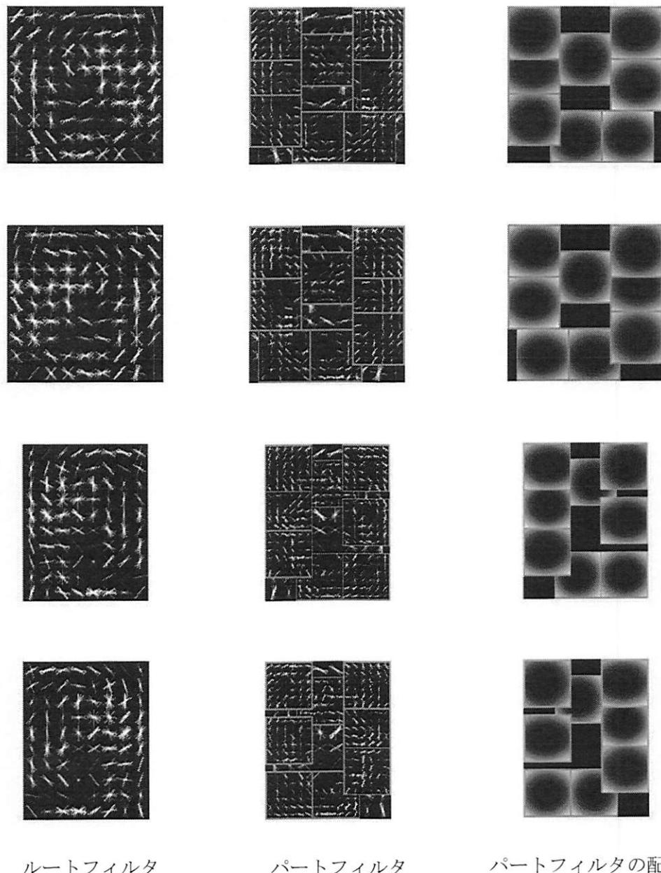
図 4.2: 4 枚のルートフィルタから構成される DPM 検出モデル
