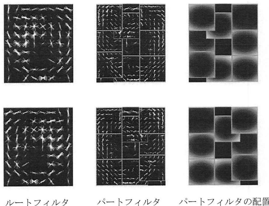
図 4.1: 2 枚のルートフィルタから構成される DPM 検出モデル
