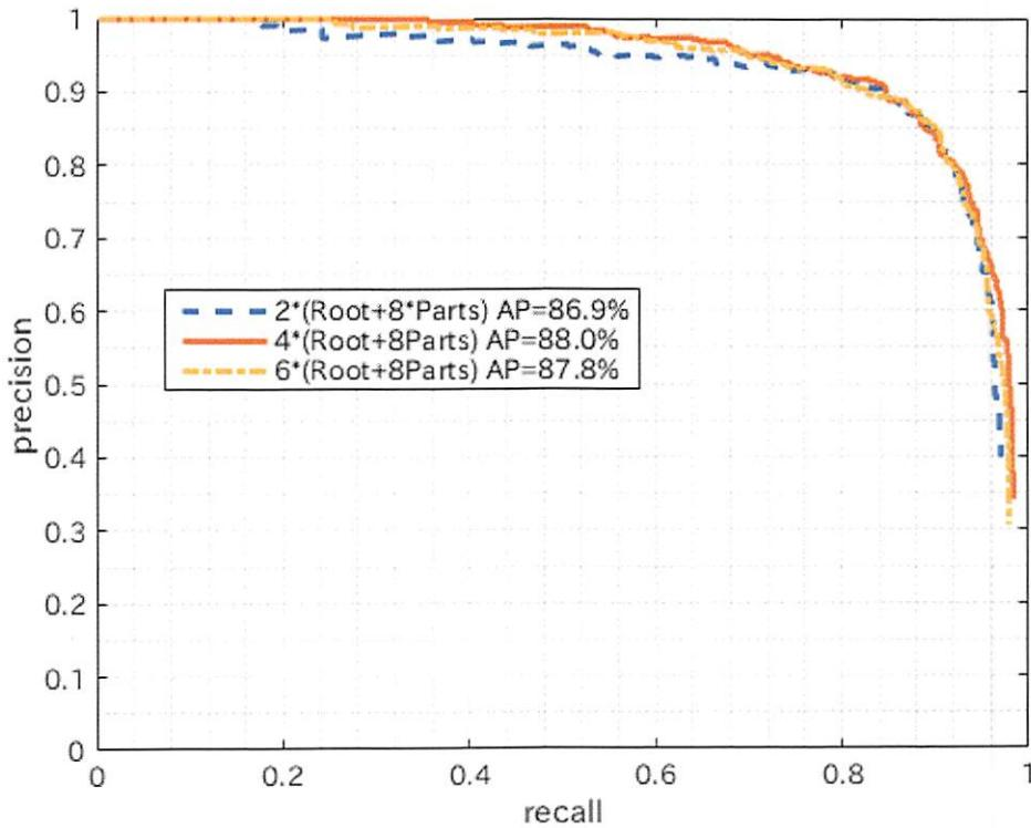
図 4.4: ルートフィルタ数による DPM の検出率変化
