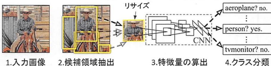
図 3.6: R-CNN の検出処理の流れ(文献[25]より引用)
