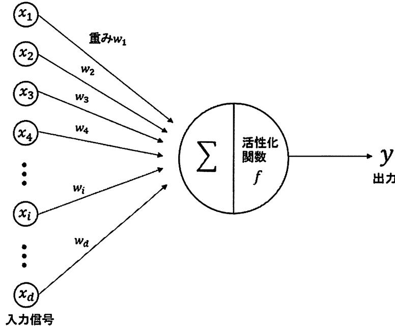
図 3.1: ニューラルネットワークのユニットの構造
