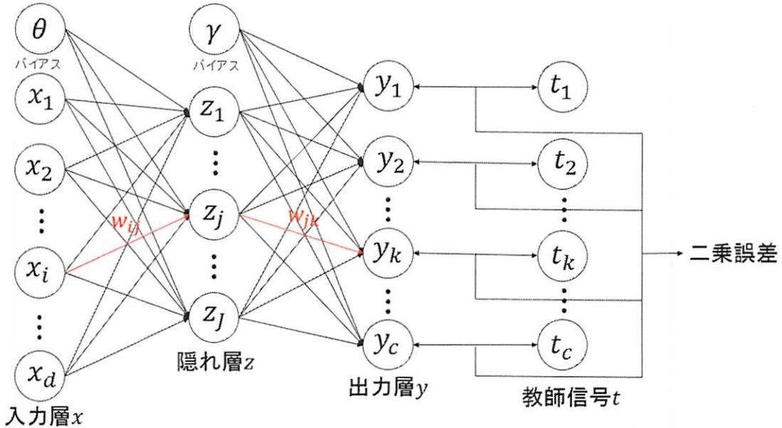
図 3.3: 多層パーセプトロンの構造
