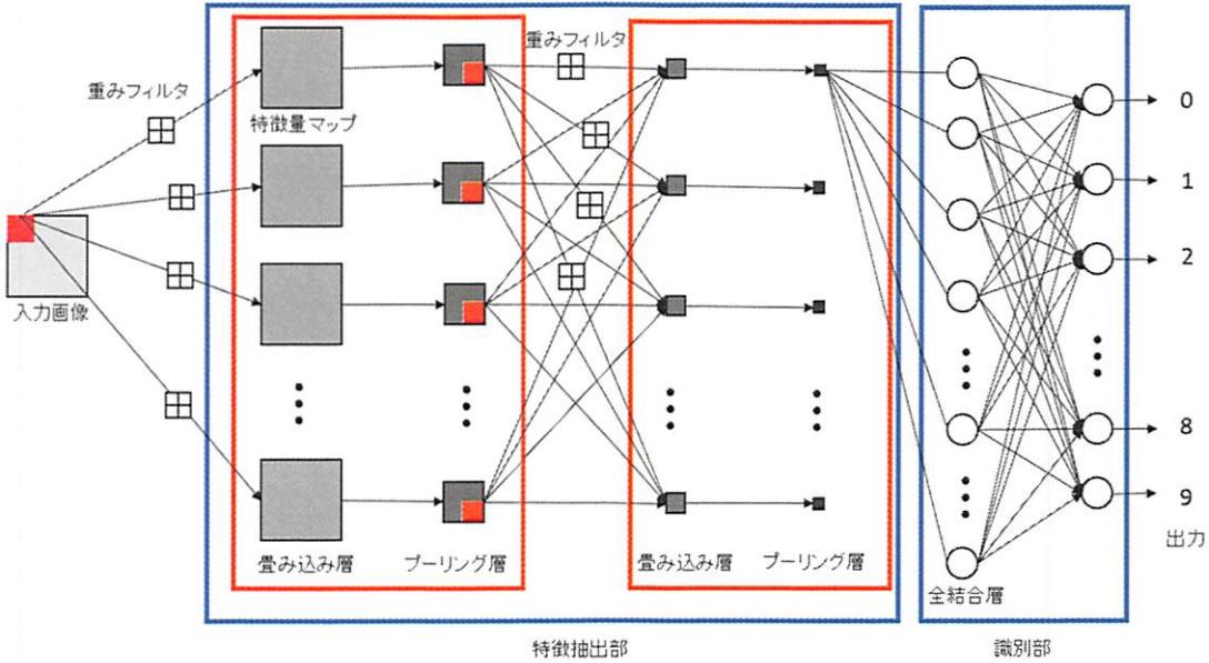
図 3.4: CNN の処理の流れ
