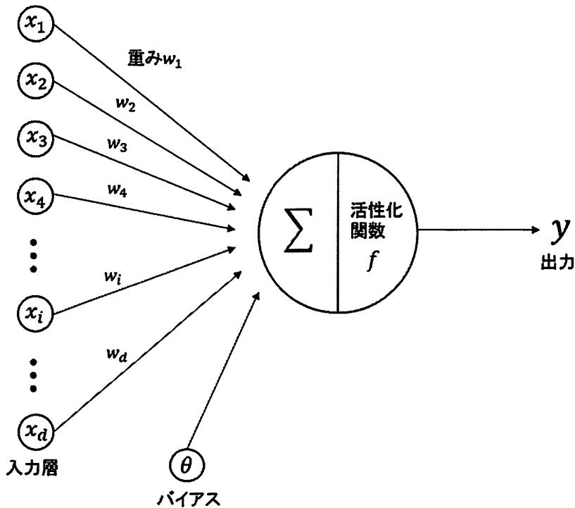
図 3.2: 単純パーセプトロンの構造
