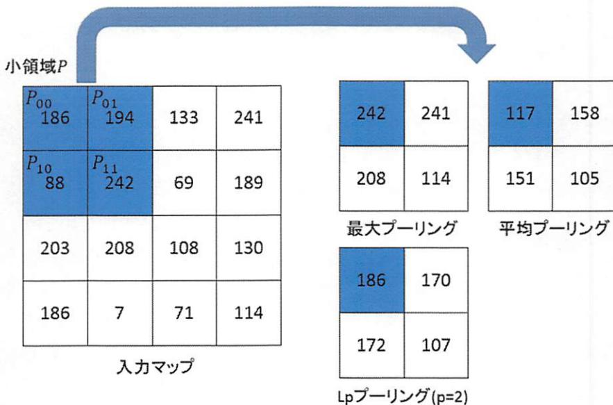
図 3.5: プーリング処理の流れ
