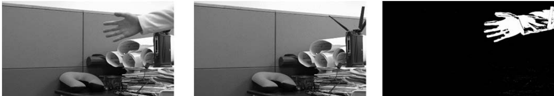
図 2.1 背景差分法の例 左:入力画像 中央:背景画像 右:背景差分画像(二値化)
